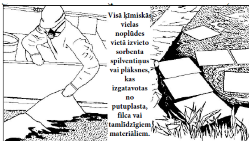
5-17. attēls. Ķīmiskas vielas noplūdes apstrāde uz ūdens virsmas ar sorbenta plāksnēm vai spilventiņiem.
